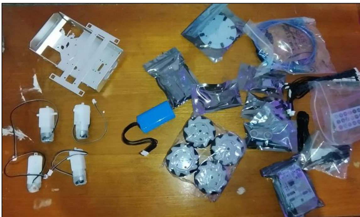
Рисунок 2.2.1 Необхідні компоненти для наземного дрона
